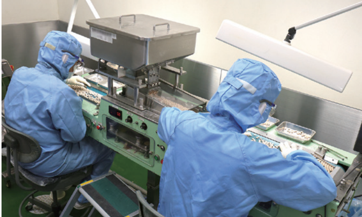
製造途中の中間検査では、専用機器や目視により、色差、重量、硬度などをチェック
