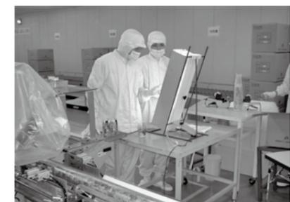
検品時は、電照板を用いて異物混入や付着など、検査項目に従って全数目視チェックを行う。
