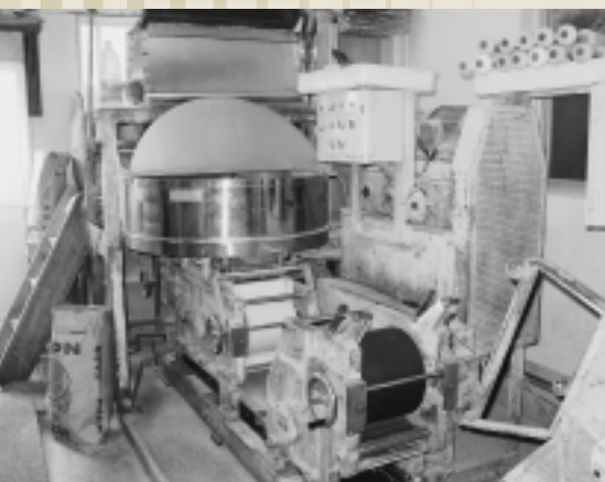
混合：ミキサーに小麦粉を入れて均一に加水しながらミキシングを行なう
