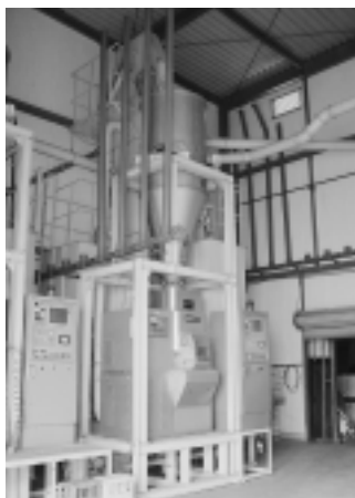
酒の種類に合わせて様々な精米歩合が設定できる全自動精米機
